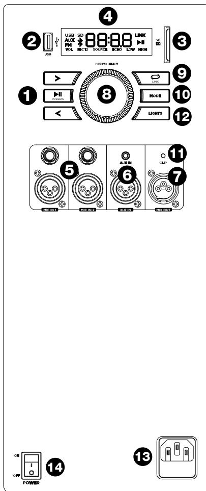
9. **Repetir / Vincular:** en modo USB o SD, presione este botón para repetir una sola pista, carpeta o todas las pistas. Mantenga pulsado este botón para iniciar el enlace estéreo a otro Total PA™ Live (consulte [ionaudio.com](http://ionaudio.com) para obtener una lista de altavoces compatibles).
