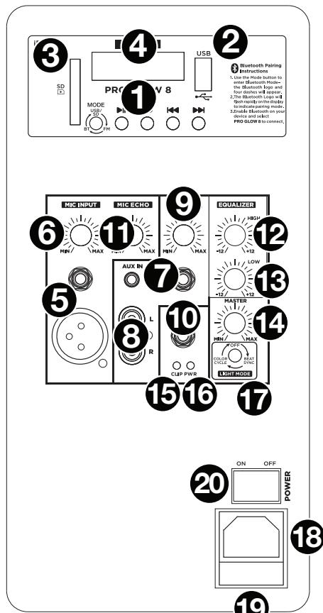
13. **Ecualización de graves:** Aumenta o disminuye las frecuencias bajas (graves) para las **entradas micrófono y línea** y las fuentes del **panel de medios** en un rango entre -12 dB y +12 dB.
